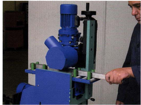
Smerigliatura di superfici piane diritte (optional) Grinding operations on straight flat surfaces (optional)
