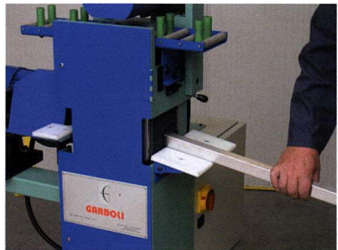
Operazioni di sbavatura e smussatura Deburring and chamfering operations
